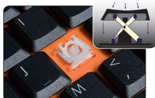
Патентованная технология клавиш „Scissors“
