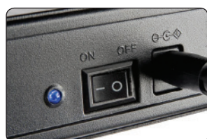
An-/Aus-Schalter und Status-LED mit zwei Modi (Betriebsbereit/Zugriff)
